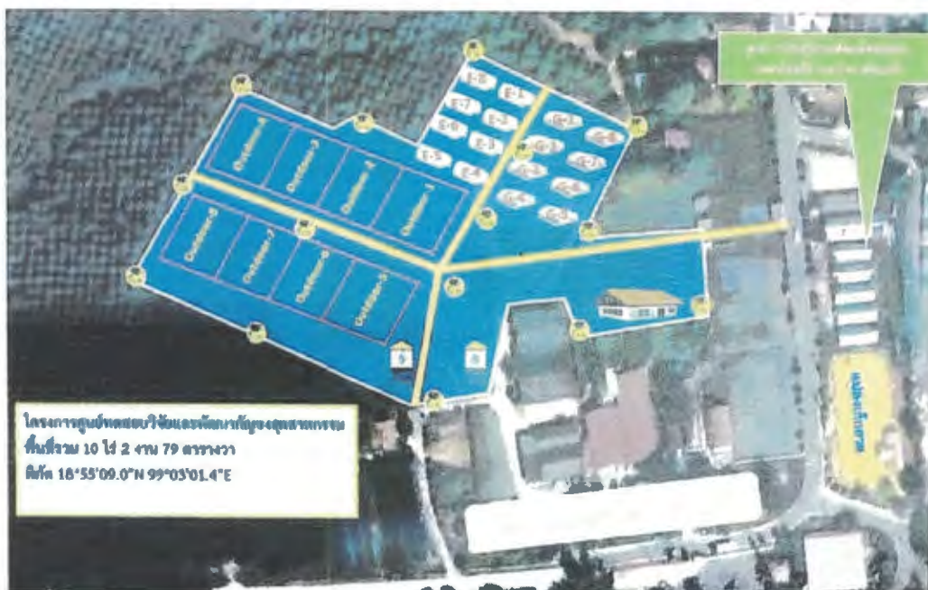
ภาพที่ 2 แสดงระบบรักษาความปลอดภัยในพื้นที่ปลูกกัญชาตำแหน่งจุดกล้องโทรทัศน์วงจรปิด และรั้วเหล็ก
