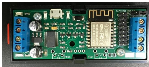
รูปที่ 9 บอร์ดควบคุมและอ่านข้อมูลเซนเซอร์แบบ i2c ร่วมกับระบบ WiFi ESP 8266
