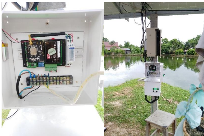
รูปที่ 11 บอร์ดตรวจวัดสภาพแวดล้อมและปริมาณการใช้พลังงานในบ่อเพาะเลี้ยงสัตว์น้ำ
