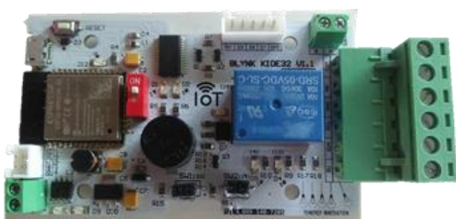
รูปที่ 10 บอร์ดควบคุมในงานเกษตรอัจฉริยะด้วยโอเพ่นซอร์สแพลตฟอร์ม (ESP32)
