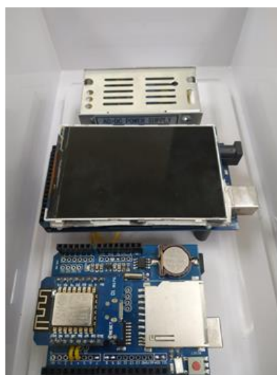
รูปที่ 12 อุปกรณ์บันทึกข้อมูลและแสดงผลผ่านระบบ IoT บนโทรศัพท์มือถือ
